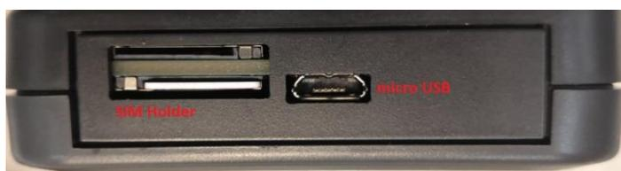
Дополнительный разъем под SIM-карту может присутствовать в некоторых модификациях устройства, но в функционировании устройства он не задействован. Его можно использовать как лоток для хранения. Он находится с другой стороны платы относительно USB разъема.
